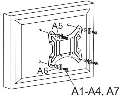
Montage an einem TV-Gerät mit vertiefter Rückseite
