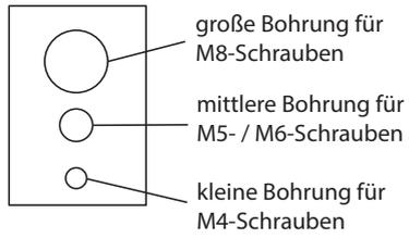
Montage an einem TV-Gerät mit flacher Rückseite
