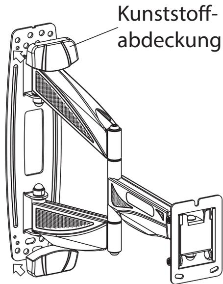
Ziehen Sie vor der Montage des TV-Geräts die obere Schraube fest um ein Herausrutschen während der Montage zu verhindern.
