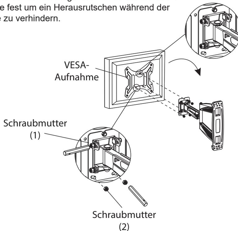
Um die Neigungsfunktion einzustellen ziehen Sie die M6-Schraubmutter fest oder lösen Sie diese (1).
